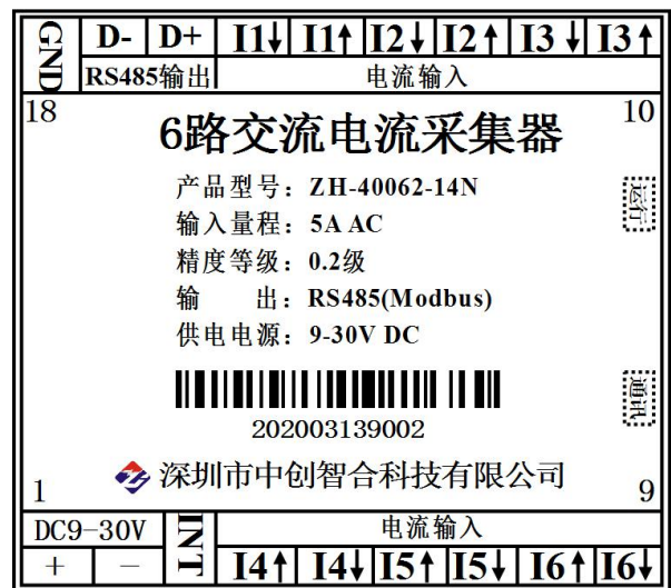
图 5.2 6路电流输入引脚定义图
